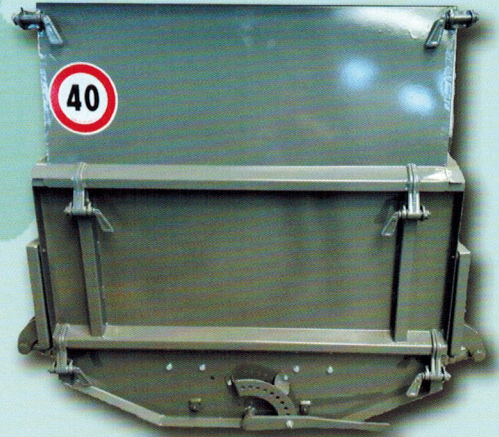
ROTORI DI FRANTUMAZIONE REGOLABILI MANUALMENTE TRAMITE MECCANISMO A LEVA.
