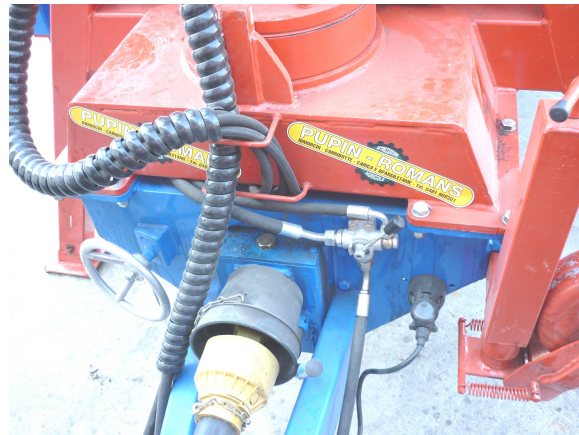
Fig 2.2 – Tubazioni idrauliche e innesti rapidi
