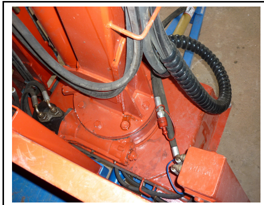
Fig 6.4: Bulloni di serraggio della ralla
