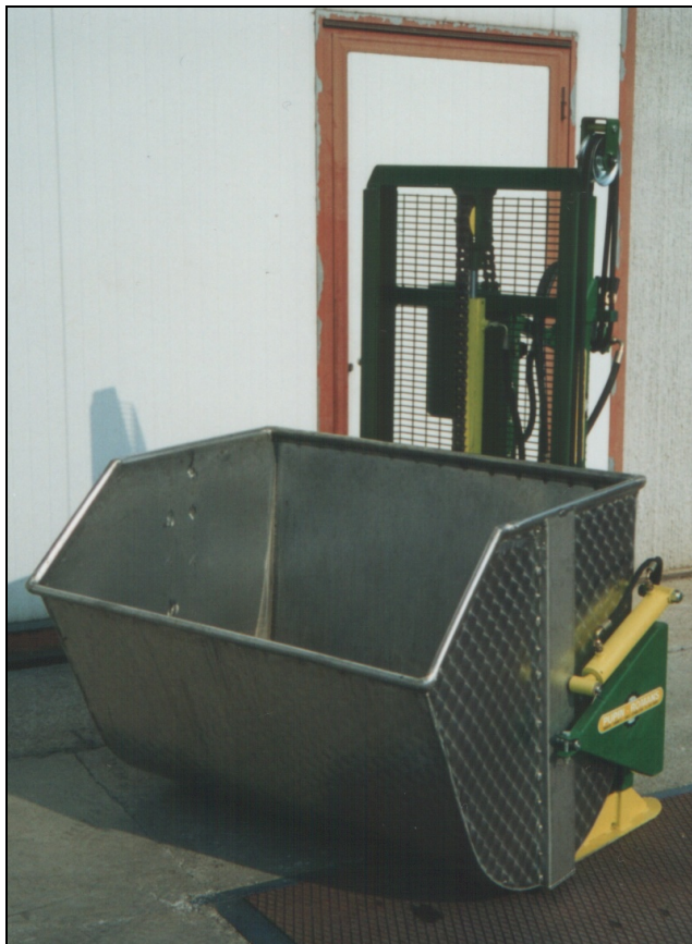
Foto 1 : Vista Anteriore del Muletto con vasca per vendemmia elevabile e ribaltabile.
